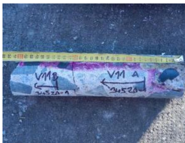
Obr.5.1-22: Odebraný vzorek betonu V11.
