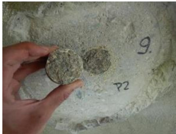
Obr. 5.4-4: Pohled na lomovou plochu odtrženého povrchu betonu v místě provedené odtrhové zkoušky.
