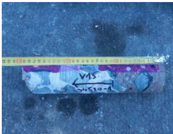
Obr.5.1-30: Odebraný vzorek betonu V15.
