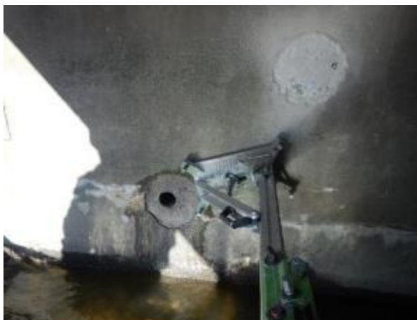
Obr.5.1-17: Pravá strana Op1 cca 0,4 m nad hladinou, odběrné místo vzorku betonu V9.
