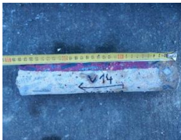
Obr.5.1-28: Odebraný vzorek betonu V14.
