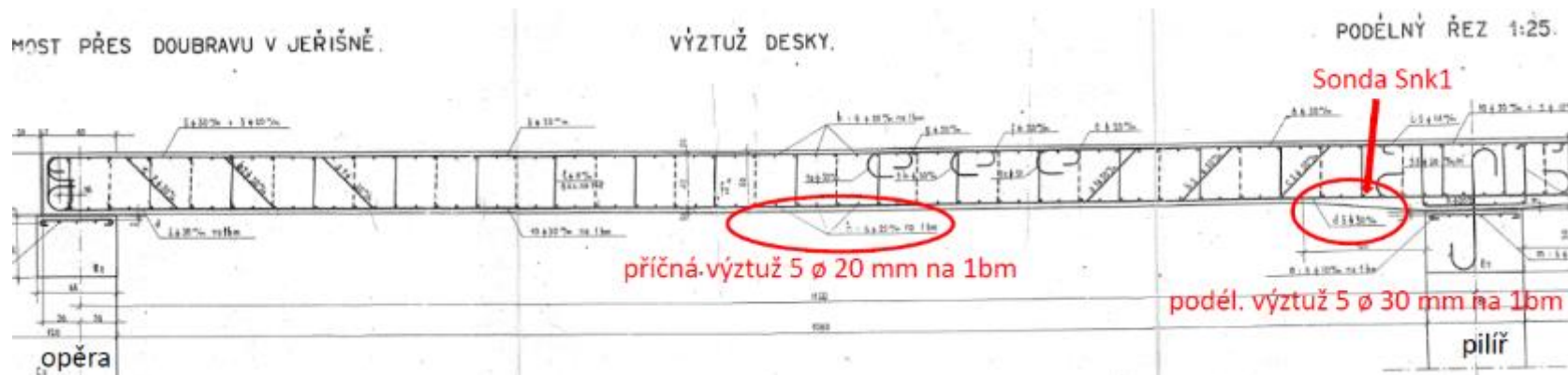
Obr. 5.3-14: Schéma vyztužení desky NK v podélném směru (převzato z dochované dokumentace).
