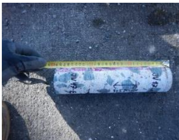
Obr.5.1-34: Odebraný vzorek betonu V17.
