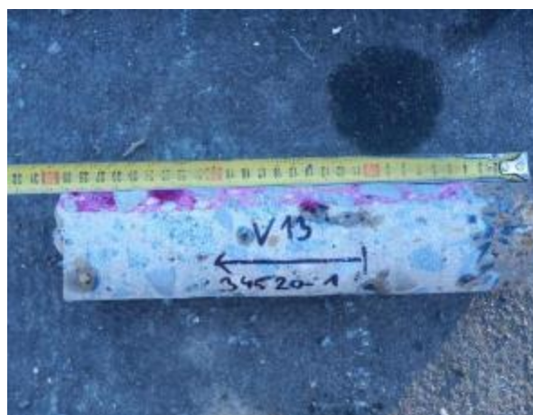
Obr.5.1-26: Odebraný vzorek betonu V13.
