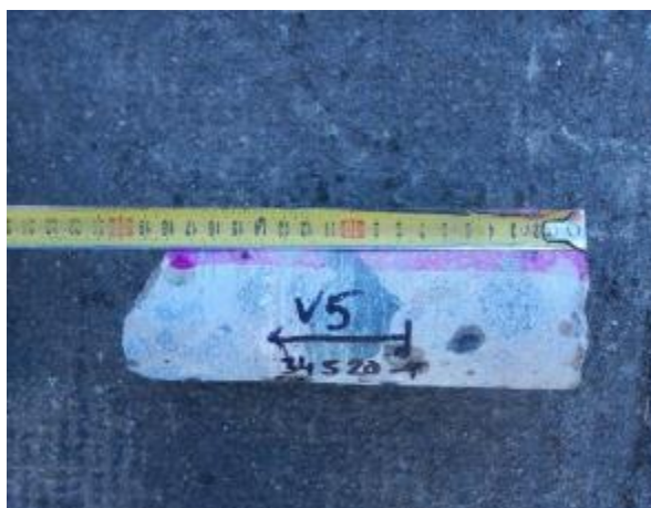
Obr.5.1-10: Odebraný vzorek betonu V5.
