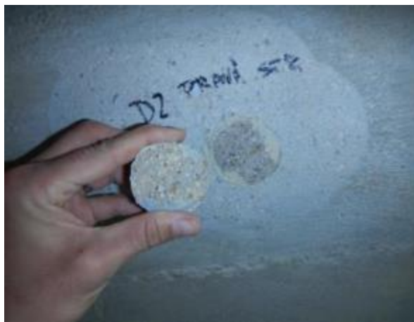
Obr. 5.4-12: Pohled na lomovou plochu odtrženého povrchu betonu v místě provedené odtrhové zkoušky.
