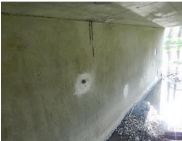
Obr. 5.4-3: Umístění nalepeného zkušebního terče T2 na P2 ze strany 2. mostního pole.
