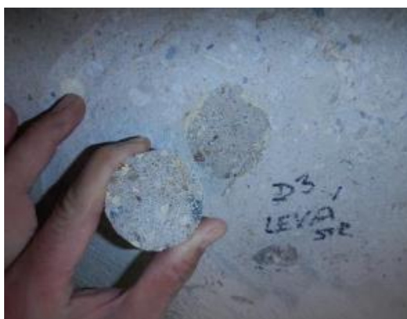
Obr. 5.4-10: Pohled na lomovou plochu odtrženého povrchu betonu v místě provedené odtrhové zkoušky.
