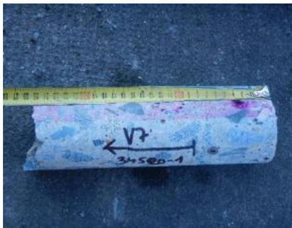
Obr.5.1-14: Odebraný vzorek betonu V7.
