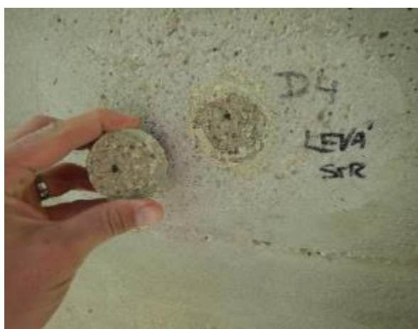
Obr. 5.4-14: Pohled na lomovou plochu odtrženého povrchu betonu v místě provedené odtrhové zkoušky.
