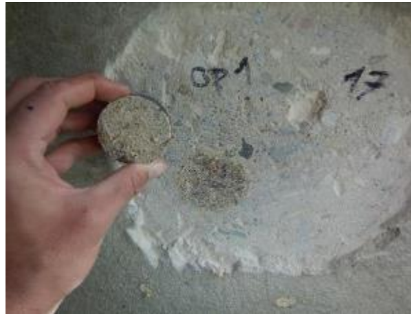
Obr. 5.4-2: Pohled na lomovou plochu odtrženého povrchu betonu v místě provedené odtrhové zkoušky.
