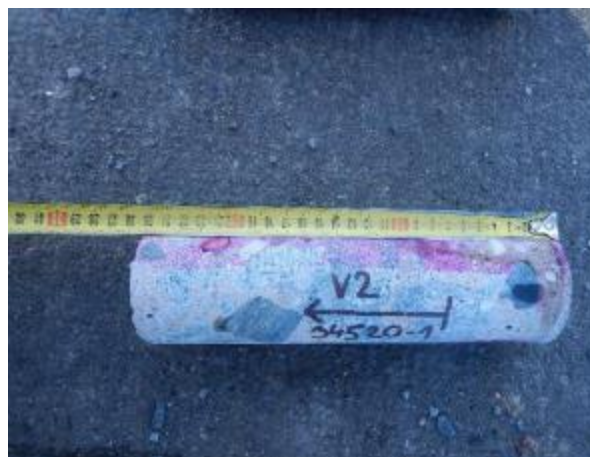
Obr.5.1-4: Odebraný vzorek betonu V2.
