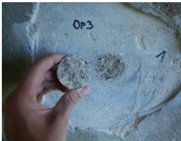
Obr. 5.4-6: Pohled na lomovou plochu odtrženého povrchu betonu v místě provedené odtrhové zkoušky.
