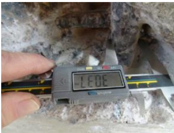
Obr. 5.3-3: Změřený průměr podélné výztuže.
