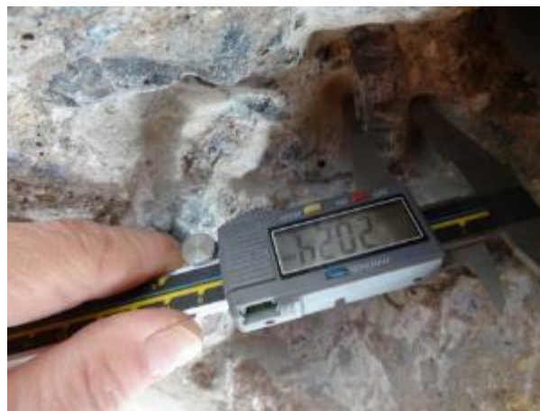
Obr. 5.3-4: Změřený průměr příčné výztuže.
