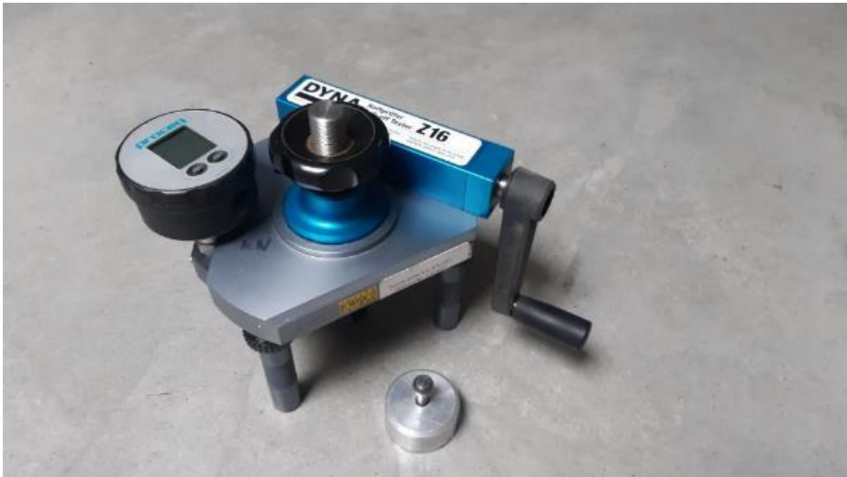
Obr. 3.5-1: Ilustrační foto trhacího přístroje firmy Proceq, model DYNA Z16
