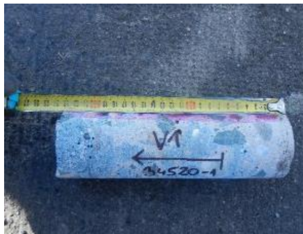
Obr.5.1-2: Odebraný vzorek betonu V1.
