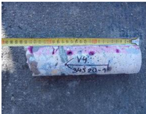
Obr.5.1-8: Odebraný vzorek betonu V2.
