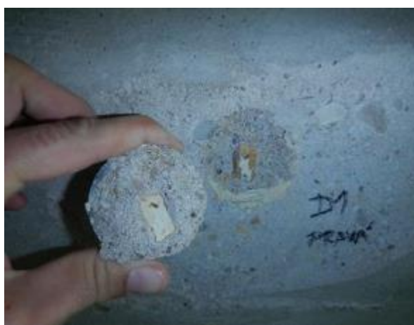
Obr. 5.4-8: Pohled na lomovou plochu odtrženého povrchu betonu v místě provedené odtrhové zkoušky.
