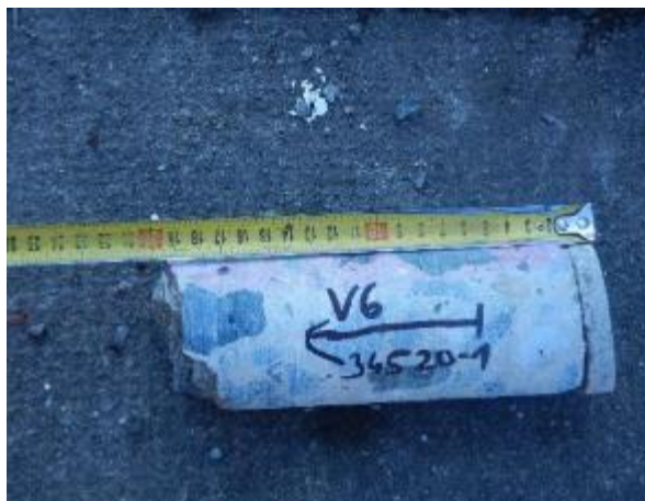
Obr.5.1-12: Odebraný vzorek betonu V6.
