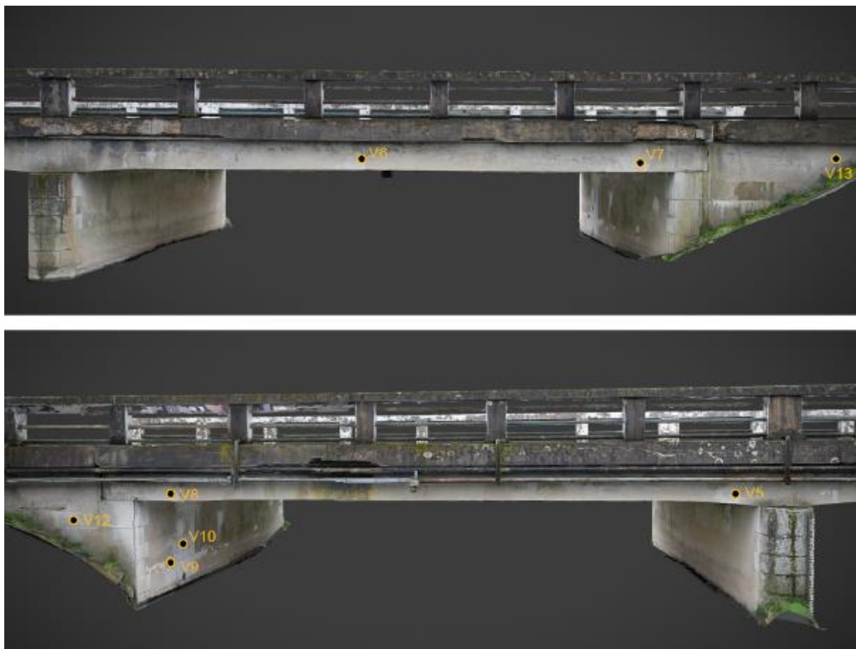
Obr. 5-2: Rozmístění odběrných míst vzorků a zkoušek betonu v 1. mostním poli v bočních pohledech. Nahoře levostranný pohled, dole pravostranný pohled.
