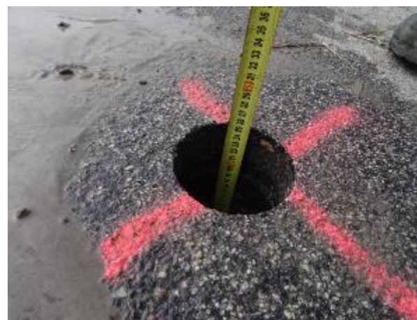
Obr.: 5.9-3: Změřená hloubka vrtané sondy.
