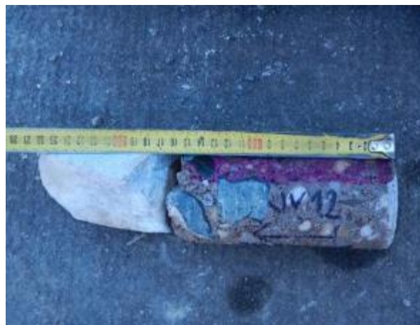
Obr.5.1-24: Odebraný vzorek betonu V12.
