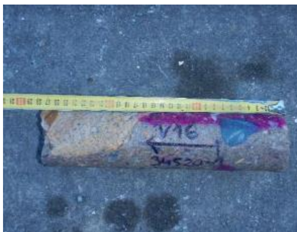
Obr.5.1-32: Odebraný vzorek betonu V16.
