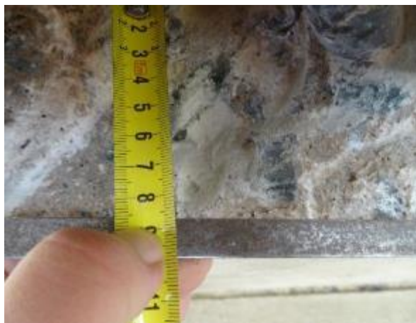
Obr. 5.3-6: Změřená tloušťka krycí vrstvy příčně výztuže v místě sondy Snk1.
