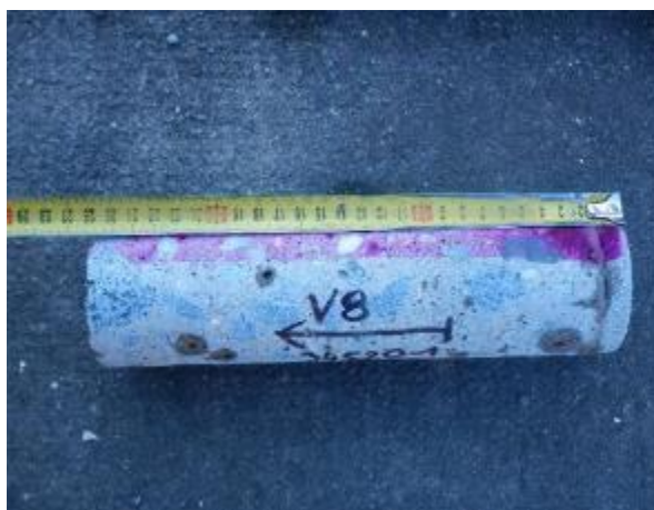
Obr.5.1-16: Odebraný vzorek betonu V8.
